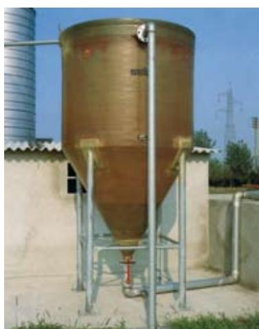
Sedimentatore-Decantatore per reflui di lavorazione, capacità 7 m<sup>3</sup>.
