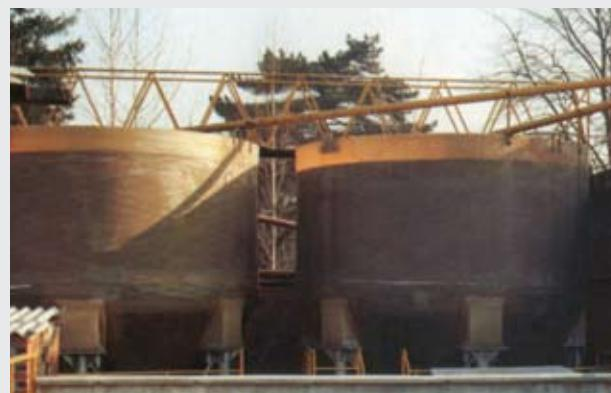
Decantatore con telaio zincato per reflui di lavorazione, capacità 54 m<sup>3</sup>.
